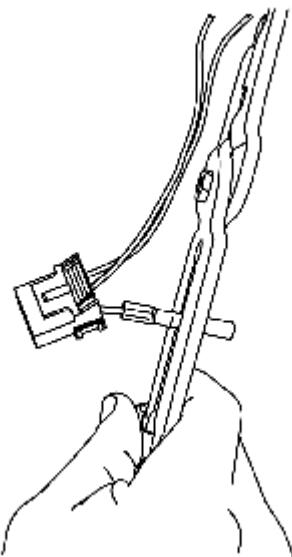
2. 使劲夹紧压接钳手柄，直至手一松开，压接钳手柄就能够打开。
