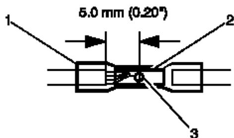
9.将DuraSeal接头套管放入嵌套中。确保压接点落在内管端部和挡块的中间。该套管在内管(2)中央有一个挡块(3)，防止导线(1)滑入。轻微夹紧压接钳手柄，将DuraSeal接头套管牢固地固定在合适的嵌套中。
