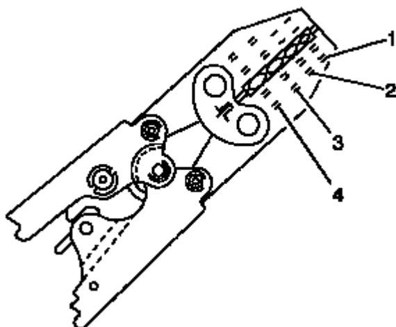
6.EL-38125-10接头套管压接工具有4个压接嵌套。最大的压接嵌套(4)用来压接10和12号导线。第二大的压接嵌套(3)用来压接14和16号导线。第三大的压接嵌套(2)用来压接18和20号导线。最小的压接嵌套(1)用来压接22至26号导线。压接槽参考压接工具嵌套颜色下的表(位置较上)。
