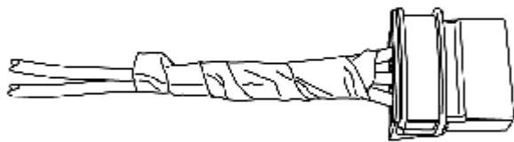
5.将额外的终端引线用胶带捆住塞回线束。
